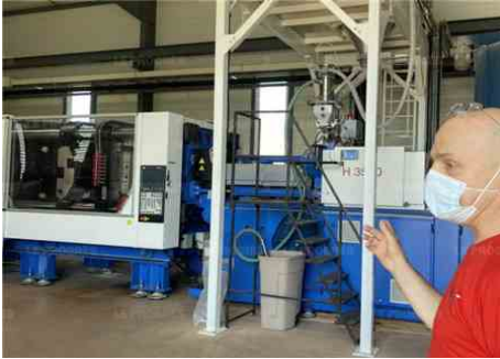
Toute la fabrication des arcs et de ses accessoires est robotisée, française et sans canaux d'alimentation, permettant l'injection de la matière directement dans le moule et donc aucun gaspillage de matière. Photos Le Progrès /Noémie CHASSIN
